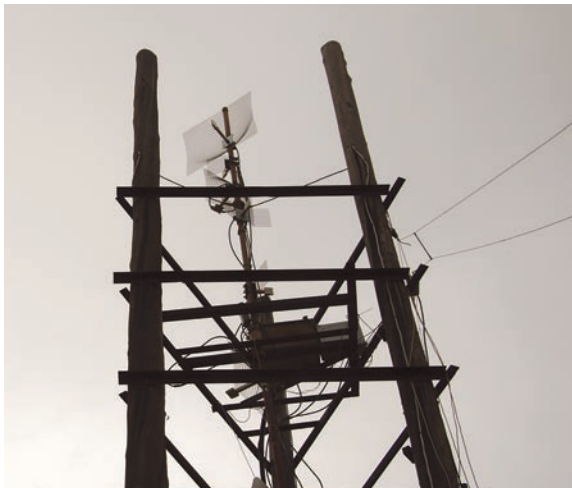
➤ Одно из самодельных реле Wi-Fi, которое связывает банк и интернет-кафе в Маче с NOC.
