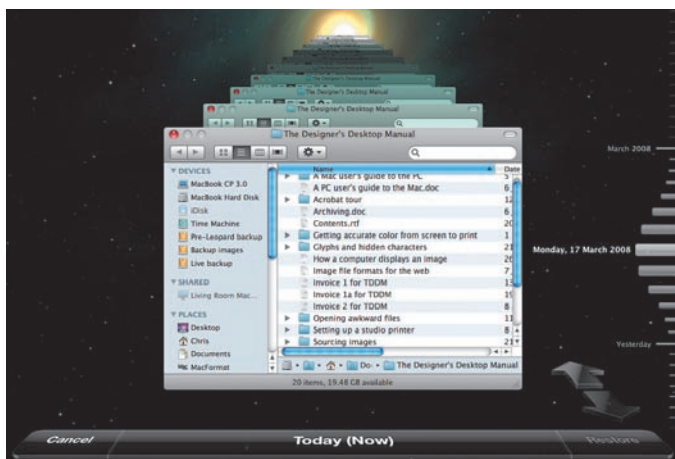
► Time Machine делает локальные снимки и автоматически связывает их с резервными копиями на внешнем носителе, при его подключении.
