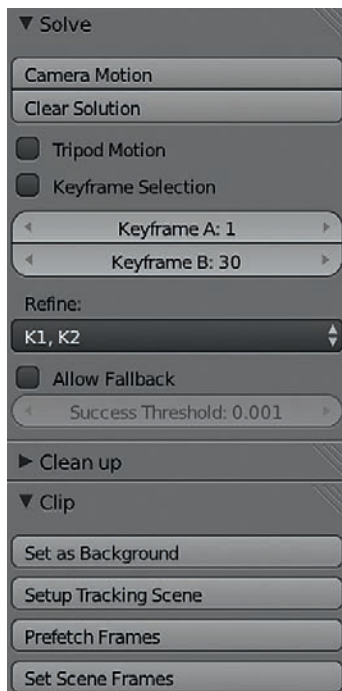
Рис. 6. Кнопки Camera Motion и Setup Tracking Scene завершают установку сцены Motion Tracking .
