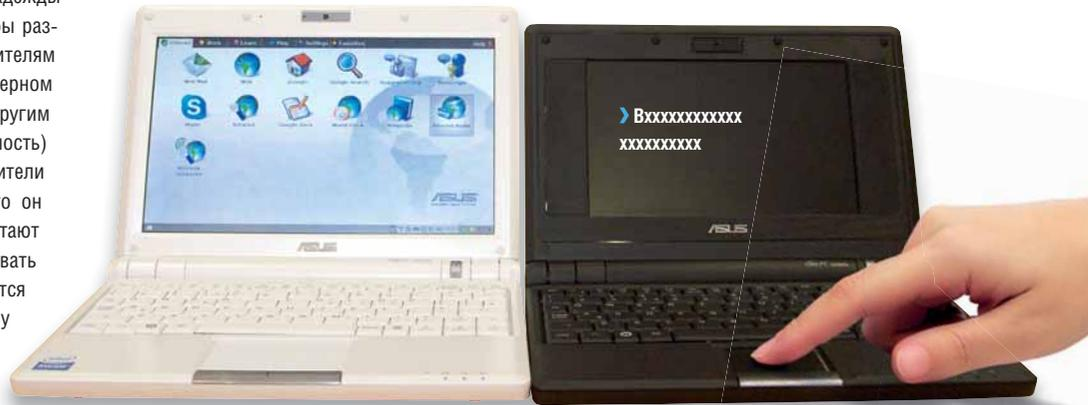
рядом с 1,3-мегапиксельной web-камерой. В то время, как процессор 701-го был ограничен сверху частотой 630 МГц ради сбережения энергии, Еее 900 держит Intel Celeron на родной частоте в 900 МГц, хотя ее можно уменьшить посредством настроек BIOS. Машина будет доступна с 1 ГБ ОЗУ и 20 ГБ места на флеш-накопителе.
